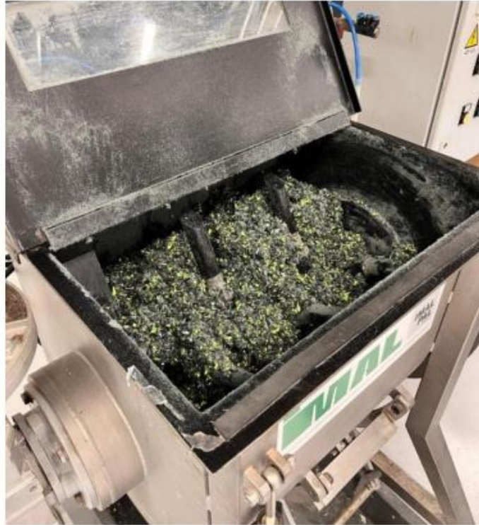
Glue-blender con el material particulado y la resina pulverizada
