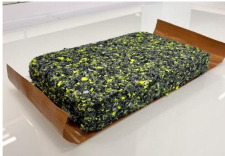
Ejemplo de bloque de compuesto polímero-partícula pre-prensa
